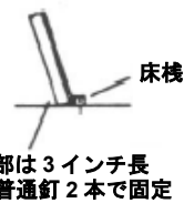
木製デッキの上に置 いた基部
