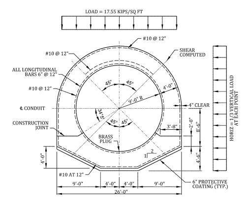
Figure D-8. Circular Conduit.
