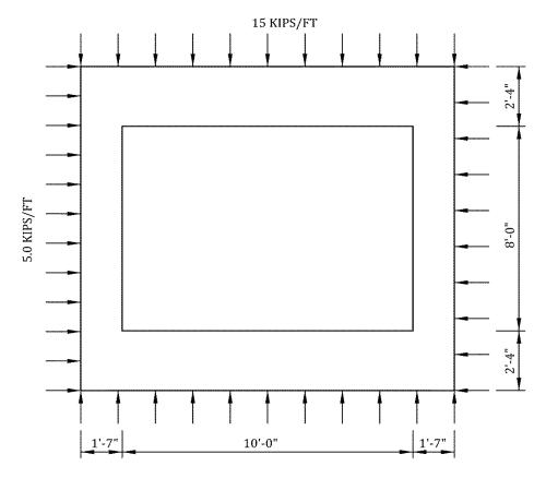
Figure D-7. Rectangular Conduit.
